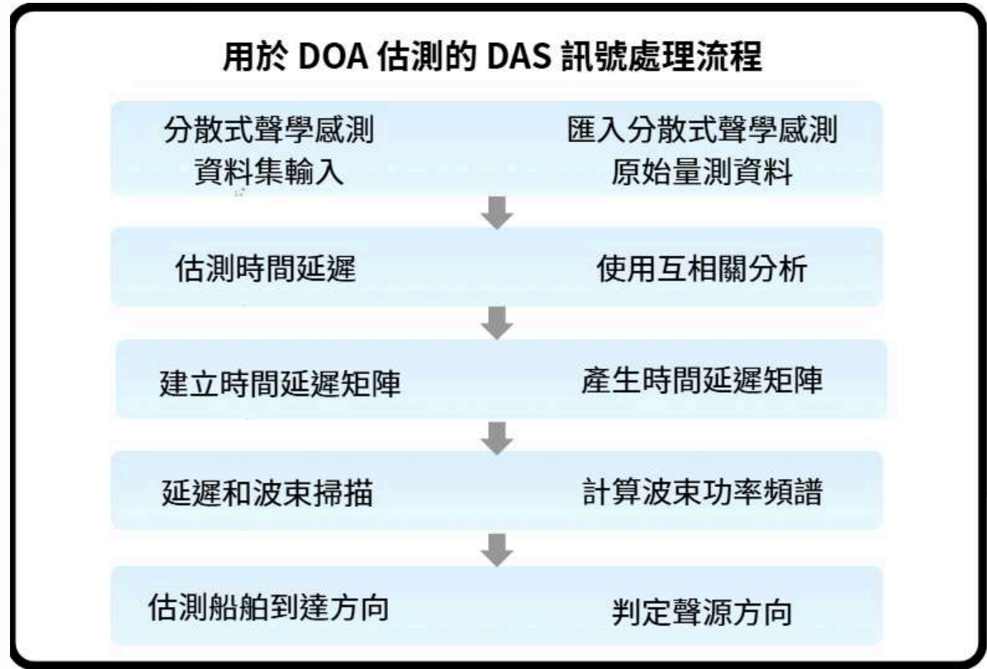
圖1. 船舶方位推估法流程圖
